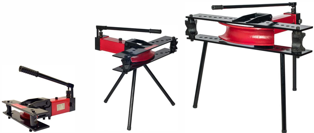
Предназначены для гидравлической гибки газовых, водопроводных и котельных труб диаметром от 1/2" до 4"(в зависимости от модели трубогиба) по ГОСТ 3262-75. Угол сгибаия от 0 до 90 градусов.
