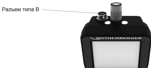
Рисунок 7 – Подсоединение кабеля (разъем типа В, серебристый, 5-контактный) (Разъем типа В используется для подключения к ROSCOPE i2000 кабелей видеоустройства ROSCOPE предыдущих версий.)
