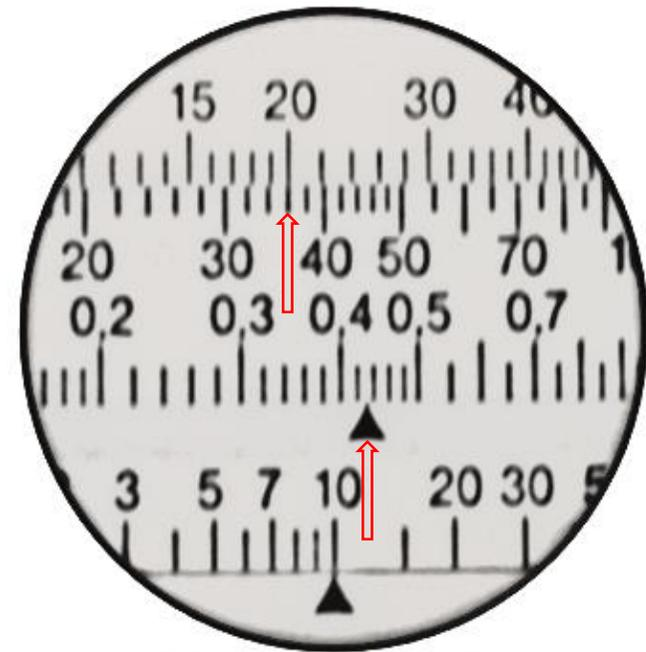
2. С помощью нижнего выдвижного элемента линейки, установите значение потерь давления в рассматриваемом контуре в кПа.
