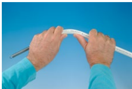
Гибка с помощью внутренней гибочной пружины
